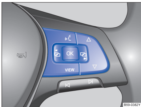
图 17 多功能方向盘右侧：用于操作信息显示器中菜单的按钮。
