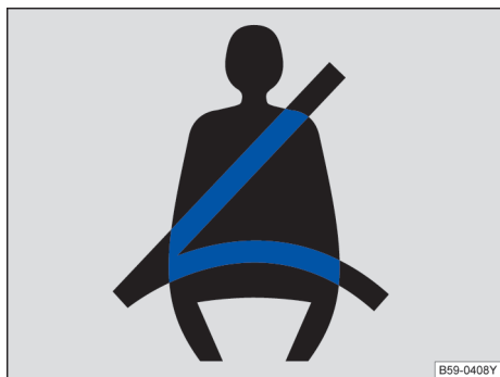
图 21 安全带未系警告灯
